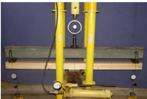
Figura 2 – Ensaio de flexão estática nas vigas de MLC
