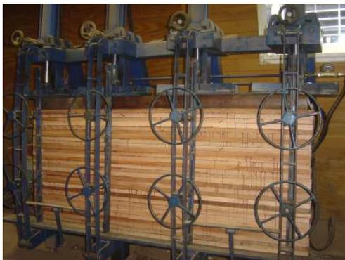
Figura 1 – Fabricação das vigas de MLC na prensa tipo “A”
